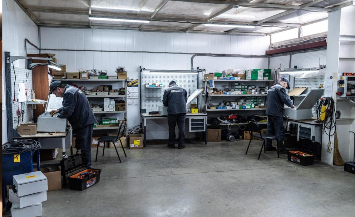
На нашем производстве так же имеется электроцех, который отвечает за комплексную сборку электрических и электронных модулей, сборку токоподвода в герлянду, а также, подключение кранов к заводским испытаниям.
