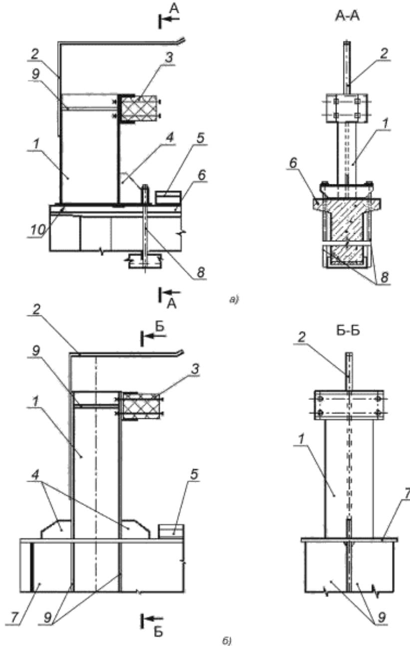
1 — стойка; 2 — ограничитель механизма передвижения крана; 3 — упругий амортизатор; 4, 9 — ребра жесткости; 5 — направляющая; 6 — железобетонная балка; 7 — металлическая балка; 8 — крепежные болты; 10 — фиксирующая плита
