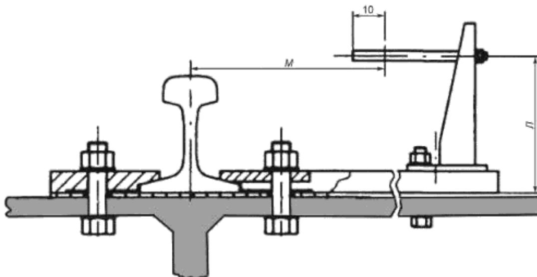
Примечание — Размеры  $M$  и  $L$ , показанные на рисунке, определяются при монтаже габаритами крана и местом установки концевого выключателя на его концевой балке.
