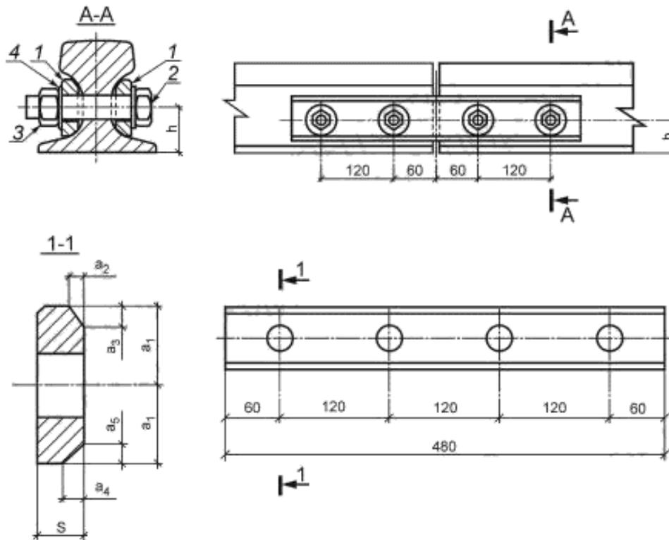
1 — боковая накладка, 2 — болт, 3 — гайка, 4 — шайба пружинная
