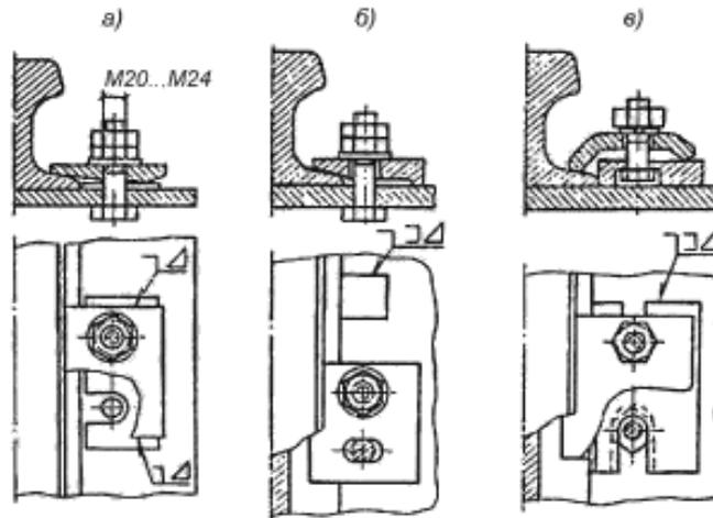
а) планка упорная расположена под прижимной планкой без сварки с подкрановой балкой; б) планка упорная расположена вне прижимной и сварена с подкрановой балкой; е) планка упорная расположена под прижимной и сварена с подкрановой балкой. Данная конструкция крепления не требует создания отверстий в подкрановой балке под крепежные болты.
